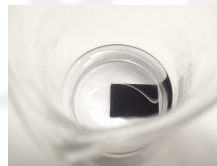
Abb. 1. gereinigtes Kupfer eingelegt in Kaliumperoxodisulfat Abb. 2. schwarz gefärbtes Kupfer nach ca. 20min
