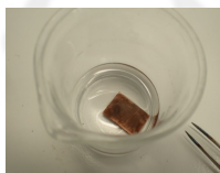
Abb. 1. gereinigtes Kupfer eingelegt in Kaliumperoxodisulfat Abb. 2. schwarz gefärbtes Kupfer nach ca. 20min
