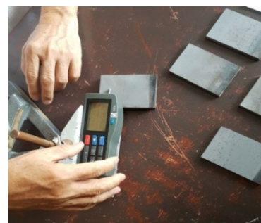
Gambar 5. Proses Pengujian Kekasaran Permukaan
