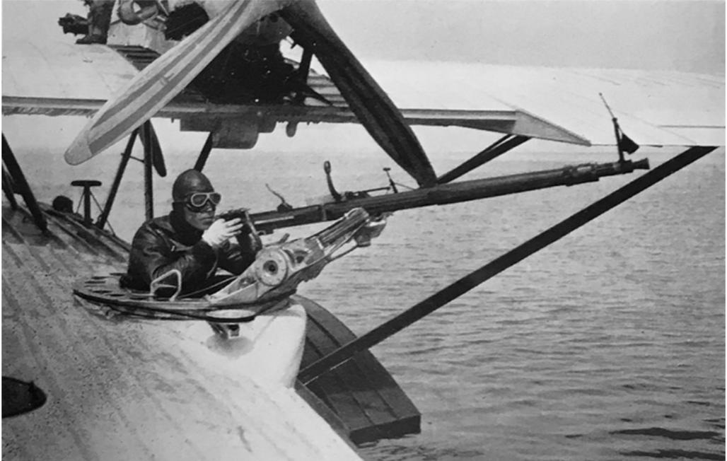
«Herr E. Bührle bedient das im Dornier-Superwal eingebaute Drehringgeschütz OERLIKON». Quelle: Ein Rückblick. Die geschichtliche Entwicklung der OERLIKON-Waffen in 20 Jahren, in: Werkmitteilungen, Mai 1945, S. 18–22.
