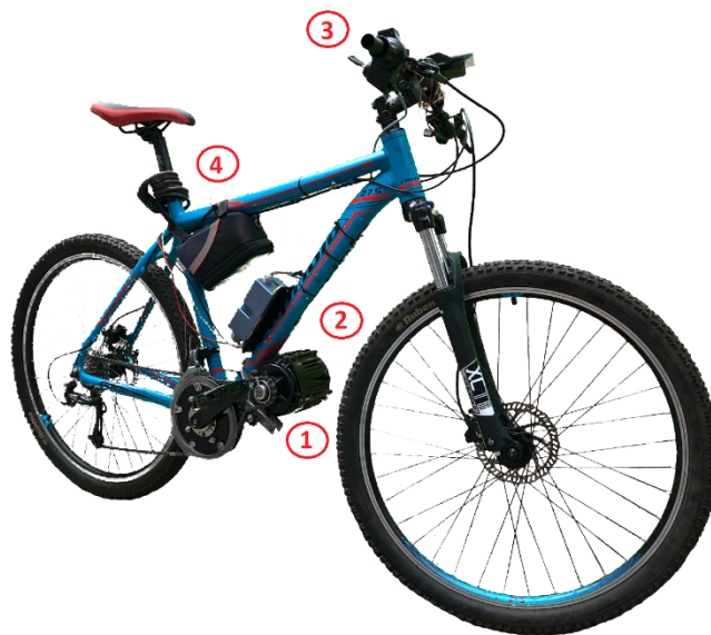
Slika 1. Realizovani električni bicikl u okviru H-Bridges tima na Elektrotehničkom fakultetu u Beogradu sa osnovnim elementima: 1) električna mašina, 2) invertorska jedinica, 3) ručica za gas i 4) baterija
