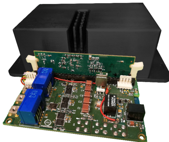
Slika 4. Razvijeni otvoreni prototip invertorske jedinice u okviru H-Bridges tima za električni bicikl
