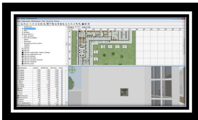
Фиг. 17. Поставяне на клавиатура за активиране и деактивиране на цялостната система за сигурност на обекта
