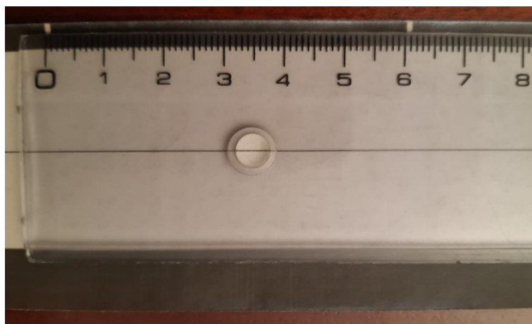
Figura 3 - Registo do sismógrafo de Milne com régua graduada para verificação da distância entre dois sinais horários consecutivos.
