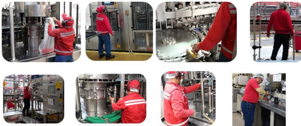
Figura 3. Actividades que se realizan en los cambios y saneamientos.
