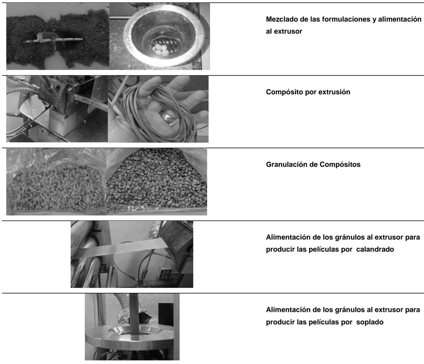
Figura 1. Esquema general de la producción de películas
