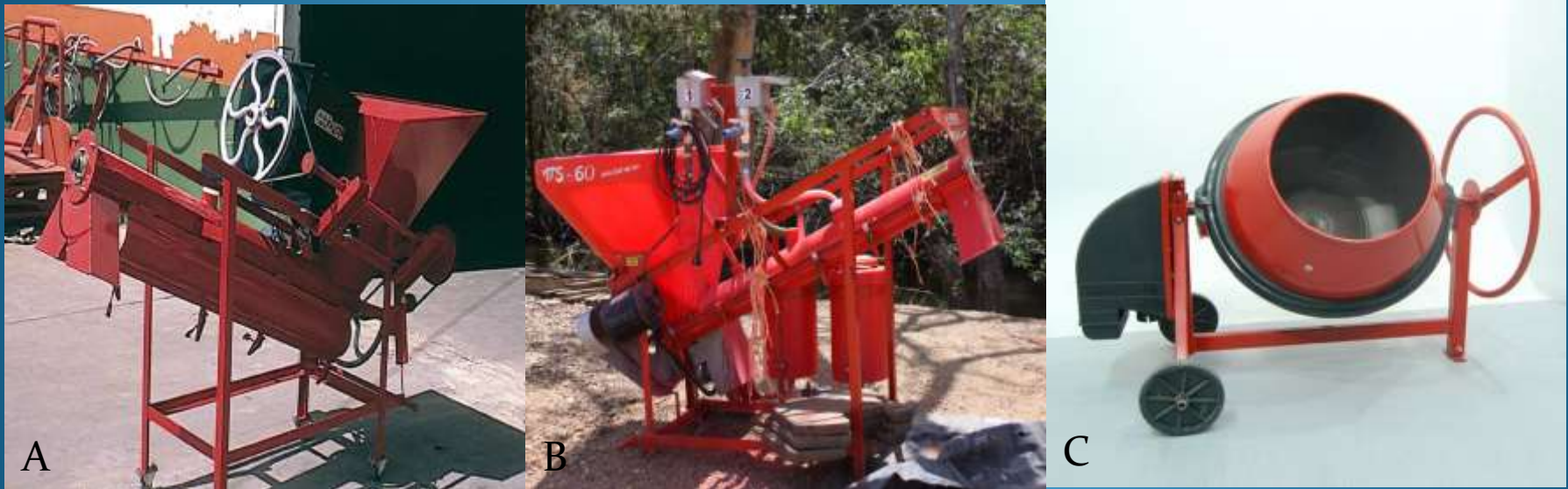
Fig. 51 Maquinaria para el Tratamiento de Semilla: Son expuestas diferentes alternativas para el tratamiento de semillas; en «A» y «B» son expuestos dos equipos diseñados, particularmente, para esta misión (Ortiz, 2018), sin embargo, un trompo para mezclar cemento «C» puede también servir, (UTEST, 2018). Las semillas suelen tratarse con hongos antagonistas de otros hongos (por ejemplo, Trichoderma harzianum ) y/o plaguicidas (como puede ser los neonicotinoides tiametoxam e imidacloprid).
