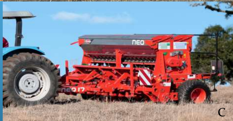
Fig. 16 Sembradoras : El tipo de sembradora a usar en un cultivo dependerá, fundamentalmente, del tamaño de la semilla y de la profundidad a la que se desea ubicar a la misma. «A» (John Deere, 2018), «B» (Einböck, 2018) y «C» (Kuhn, 2018).
