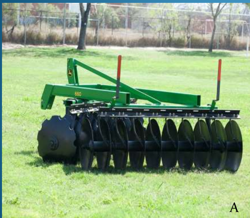
Fig. 12 Rastra de Discos: Un implemento que suele usarse para la labranza secundaria. En «A» puede verse una rastra de discos (John Deere, 2018) y en «B» su modo de trabajo (John Deere, 2018).
