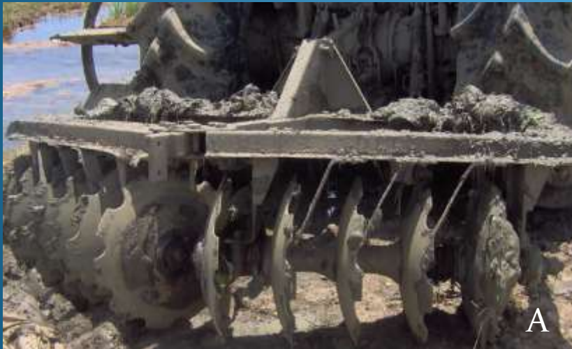
Fig. 9 Equipos Convencionales para la Práctica del Fangueo: En «A» puede visualizarse una yona (Ortiz, 2018), en cambio, en «B» es mostrado un tractor con una rastra de disco de arrastre y con las ruedas acopladas a cestas batidoras (Almaráz, 2014), sin embargo, para la práctica del fangueo pueden acoplarse equipos rutinarios en el arado secundario (el propósito es sólo mezclar la tierra ya suelta en el proceso de arado con el agua).
