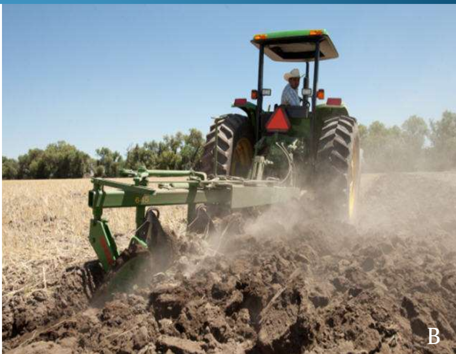
Fig. 10 Arado de Discos: Un implemento que suele usarse para la labranza primaria. En «A» puede verse un arado de discos integrado (John Deere, 2018) y en «B» su modo de trabajo (Camosa, 2018).
