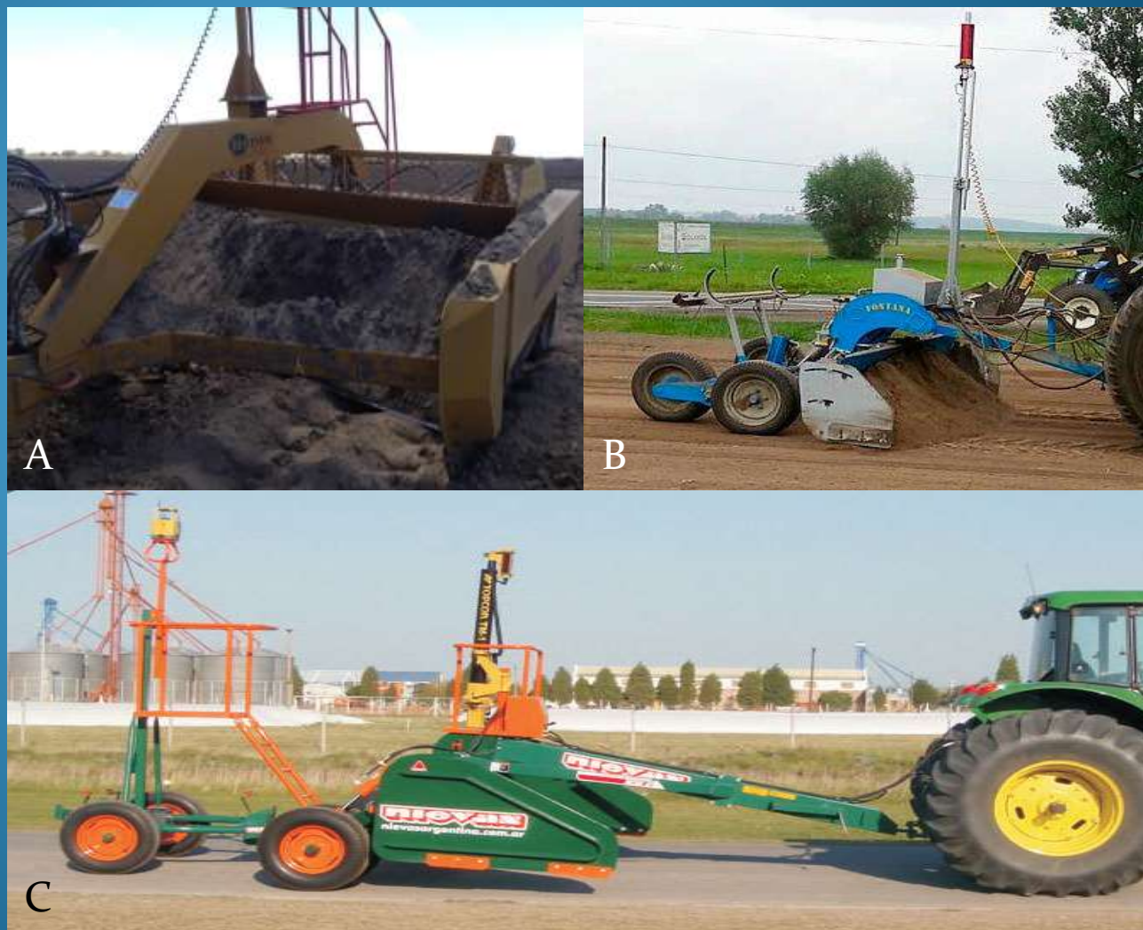
Fig. 11 Pala Niveladora: Es sugerido que las palas de nivelación que vayan a ser usadas estén reguladas con laser para corregir, incluso, desniveles pequeños (micronivelación). «A» (Ortiz, 2018), «B» (Fontana, 2018) y «C» (Nievas, 2018).
