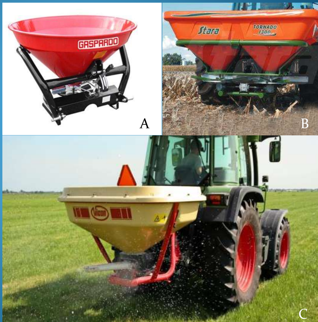
Fig. 15 Trompo Abonador: Funciona para la dispersión de partículas de diferentes naturalezas, siempre y cuando las mismas sean de un tamaño proporcional, por ejemplo, a granos de Lens culinaris Medik. (lenteja). «A» (TETTERSAI, 2018), «B» (TodoAgro, 2018) y «C» (Vicon, 2018).
