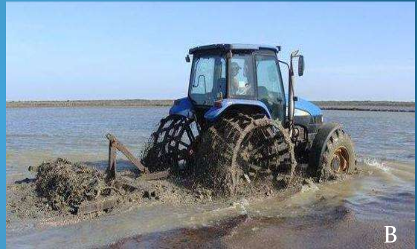
Fig. 9 Equipos Convencionales para la Práctica del Fangueo: En «A» puede visualizarse una yona (Ortiz, 2018), en cambio, en «B» es mostrado un tractor con una rastra de disco de arrastre y con las ruedas acopladas a cestas batidoras (Almaráz, 2014), sin embargo, para la práctica del fangueo pueden acoplarse equipos rutinarios en el arado secundario (el propósito es sólo mezclar la tierra ya suelta en el proceso de arado con el agua).
