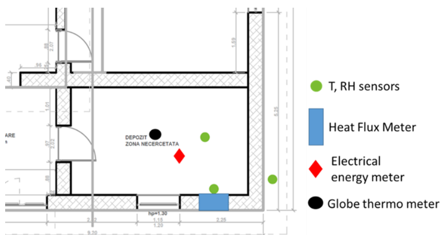
Slika 77: Oprema za spremljanje preizkušanja plošč za kontaktne izolativne fasade
