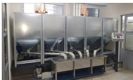
Slika 47: Predhodno mešanje trdnih surovin v zalogovniku mešalnika
