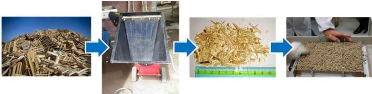
Slika 29: Proces izdelave lesno geopolimernih plošč
