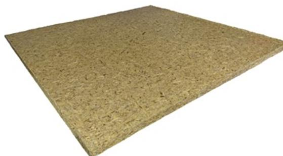
Slika 28: Izgled lesno geopolimernih plošč
