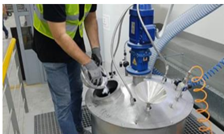
Slika 49: Mešanje polipropilenskih vlaken s kalijevim silikatom v glavnem mešalniku
