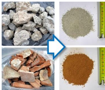
Slika 10: Agregati s premerom zrna < 2 mm, pridobljeni s predelavo CDW-ja
