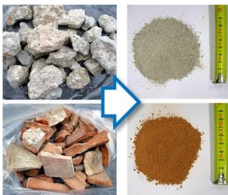
Ryc. 10. Kruszywa mniejsze niż 2 mm otrzymane z przetwarzania CDW
