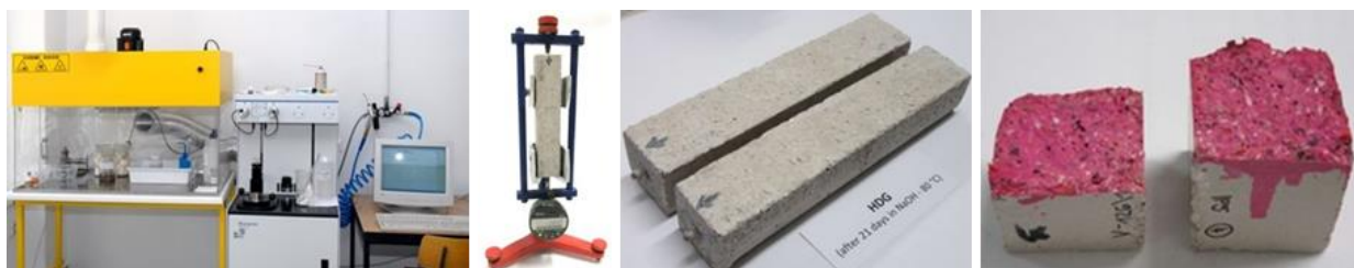
Ryc. 30. Przykłady sprzętu i próbek do badań materiałów (porozymetria Hg, zmiana długości w teście ASR, odporność na karbonatyzację)
