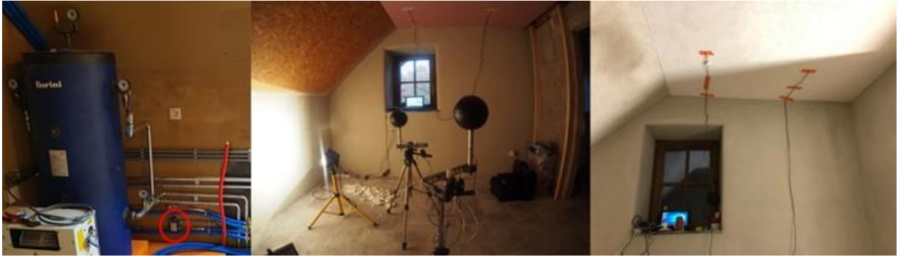
Ryc. 80. Sprzęt monitorujący do pomiaru wydajności promieniujących paneli sufitowych
