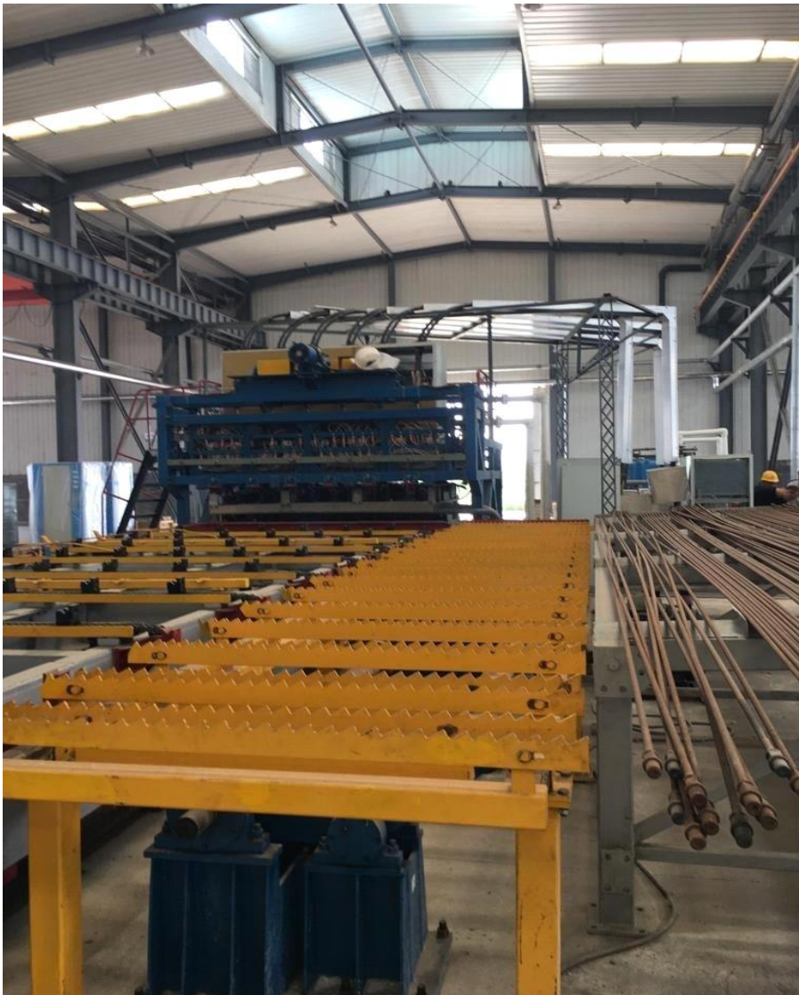
Рис.7. Установка термической обработки заготовок штанг ( без механической обработки)
