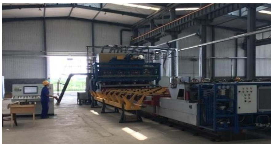
Рис.6. Установка термической обработки заготовок штанг ( без механической обработки)
