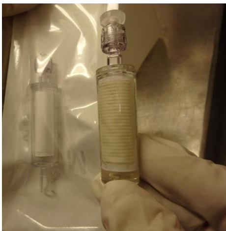
Figur 7. Slutligen förslöts kapseln och provet lagrades i frys.
