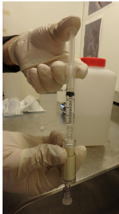
Figur 6. Därefter konserverades proverna med etanol.
