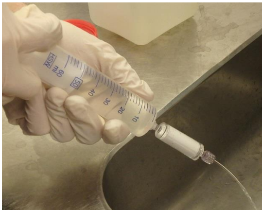
Figur 5. Vattenproverna filtrerades genom ett Sterivex-filter.
