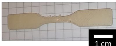
Figura 1. Pieza fabricada para ensayo de tracción.
