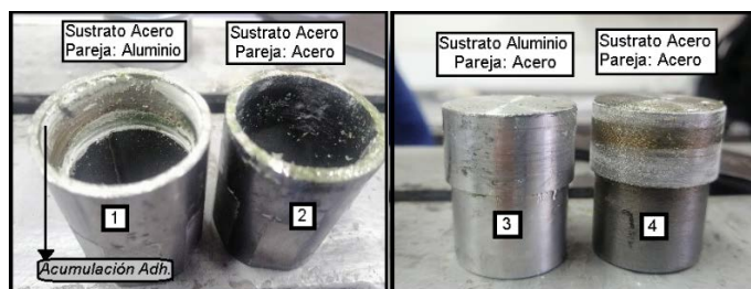
Figura 8. Resultado físico de la prueba en cuatro sustratos
