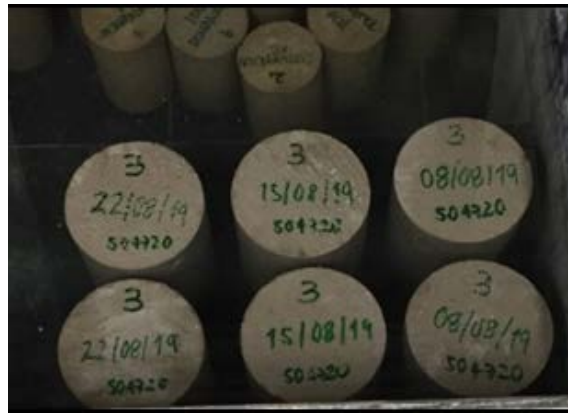
Figura 3. Curado de cilindros concreto reforzado
