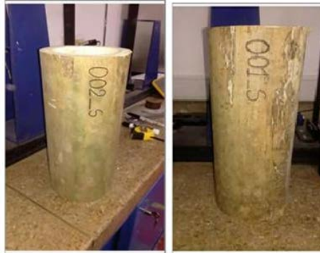
Figura 2. Daños Presentados en la Guadua AK
