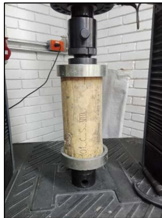
Figura 5. Ensayo a compresión paralela a la fibra, muestra de 15 cm de diámetro
