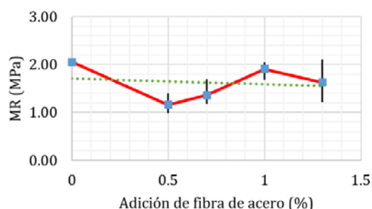
Figura 1. Módulo de rotura de probetas con adición de fibra de acero
