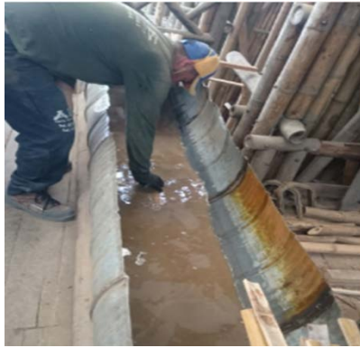
Figura 6. Culmos de guadua inmersos en ácido de bórax
