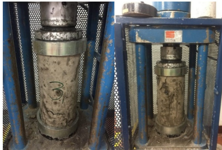
Figura 4. Compresión muestras de concreto
