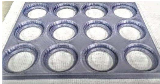
Figura 2. Matriz de ensamble de probetas de ensayo
