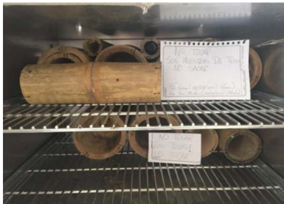
Figura 1. Probeta de guadua en estado verde puesto al horno
