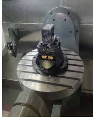
Figura 10. Ubicación del bloque del polímero Nylon en el MS de la CNC
