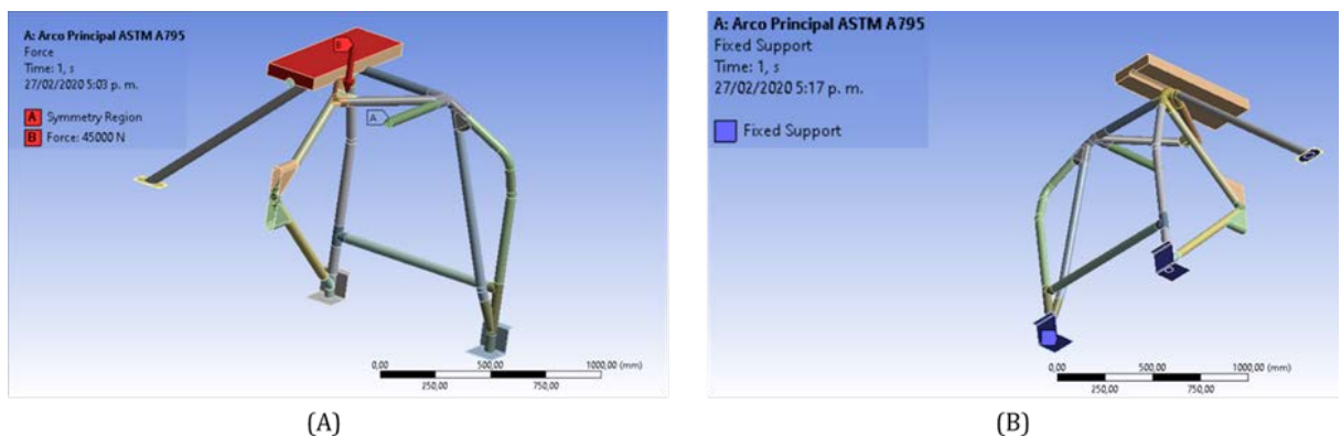
Figura 5. Condiciones de frontera ensayo sobre arco principal: (A) Condiciones de fuerza y simetría, y (B) Condiciones de fijación
