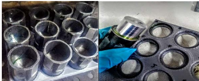
Figura 5. Proceso de curado en matriz mediante horno eléctrico
