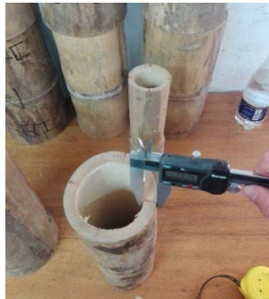
Figura 3. Medición de espesor de pared
