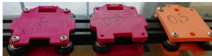
Figura 9. Tolerancia de los rodamientos tipo Derlin
