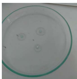
Figura 2. Disolución pellets de EPS
