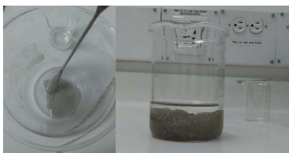
Figura. 6 mezcla EPS, Limoneno y etanol
