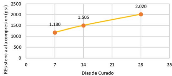
Figura 8. Resistencia concreto con 50% más de fibras de guadua AK en estado natural
