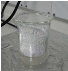
Figura 3. Disolución de EPS en D-limoneno
