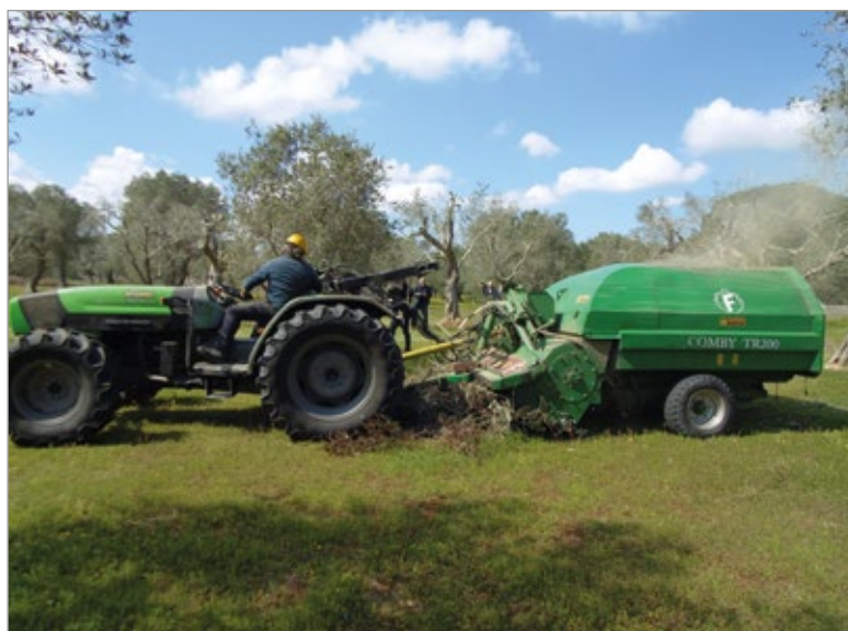
Figura 2 - Raccolta delle potature di olivo tramite trinciatrice dotata di sistema di convogliamento del prodotto nel cassone della macchina.
