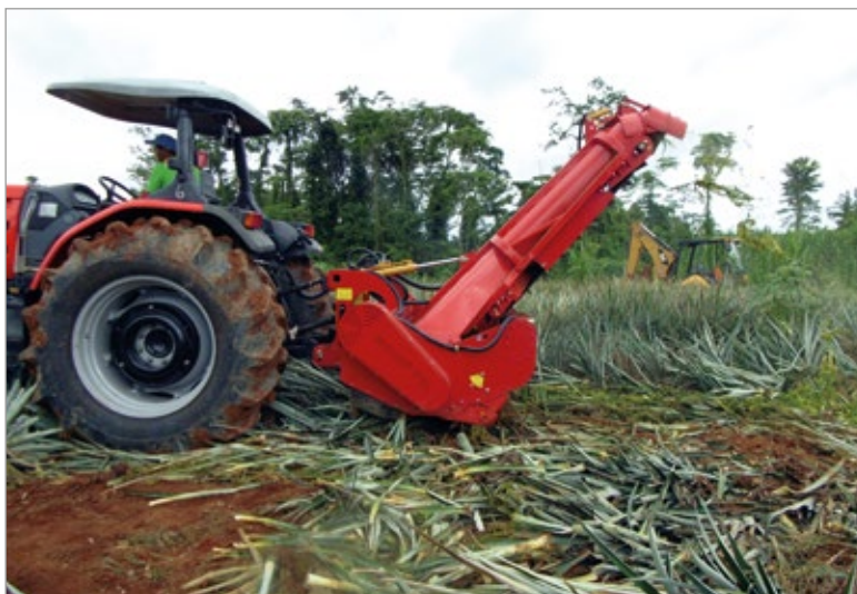
Figura 4 - Trincia forestale Seppi Midforst Drago durante le operazioni di raccolta.
