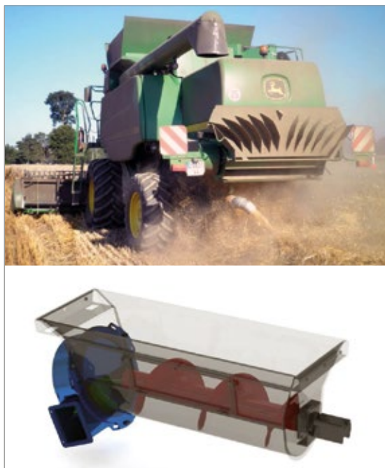
Figura 5 - Sistema a turbina Thievin con scarico sull'andana.
