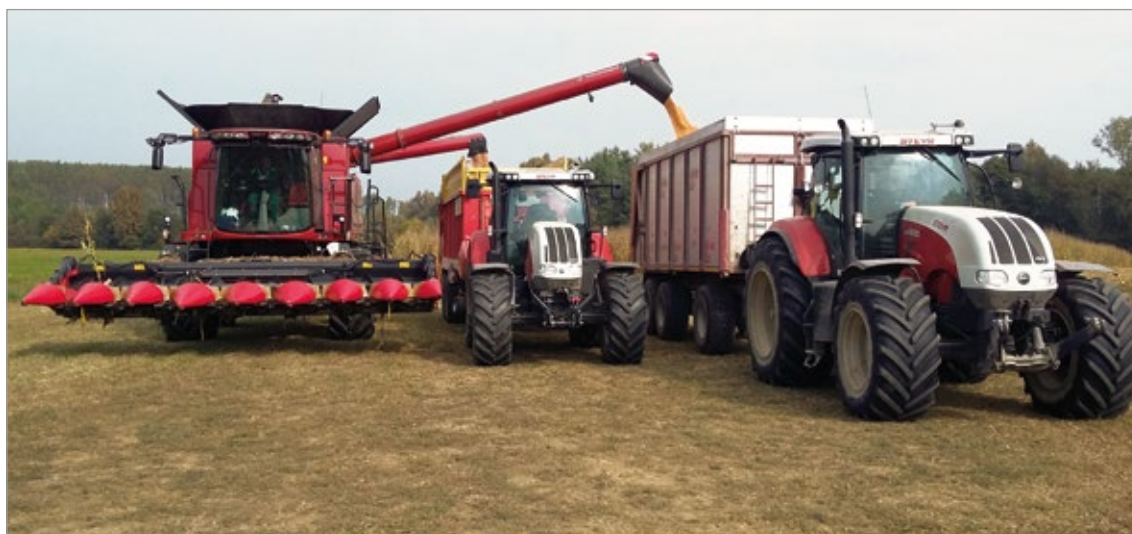
Figura 2 - Vista del sistema di scarico della granella e dei tutoli di mais.
