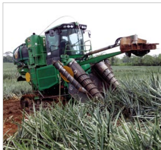
Figura 3 - Macchina per la raccolta della canna da zucchero JD3520.
