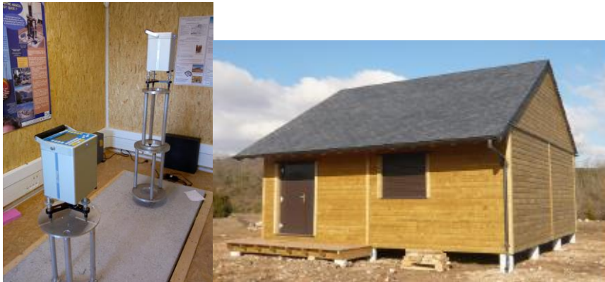
Figure 14. Vertical gravity gradient survey inside GEK-observatory, L'hospitalet-du-Larzac, France. Left: Relative gravimeters measure gravity placed on tripods of different heights. (Photo: Cooke, 2017) Right: Observatoire Géodésie en Environnement Karstique (GEK). (Photo: Le Moigne, 2011)
