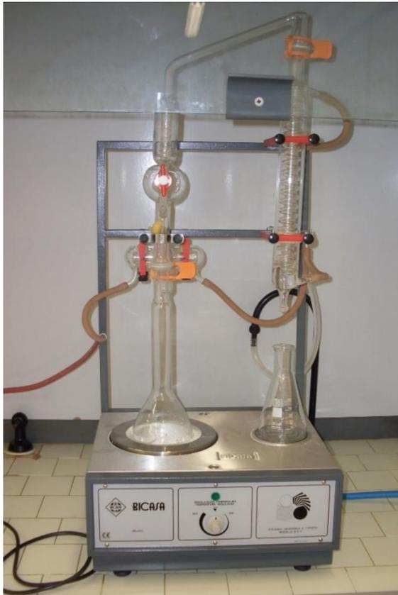
Gambar 7.7. Set alat analisis Kjeldahl
