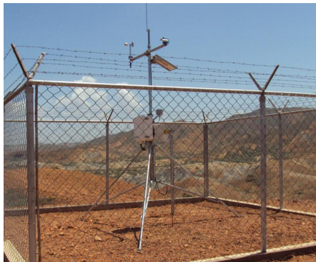
Fig. 2. Estación Meteorológica Astillero Nororiental, en el interior una estación automática Campbell CR 1000.
