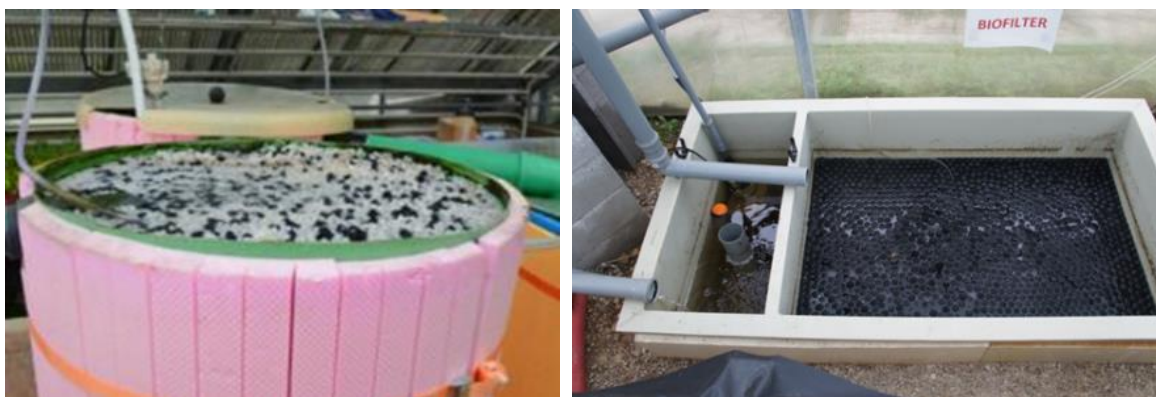
Figura 10: Dos versiones de biofiltros de medios móviles subóptimos: (izquierda) biofiltro que contiene demasiados biochips (foto R. Bolt); (derecha) biofiltro sin aireación (foto U. Strniša)
