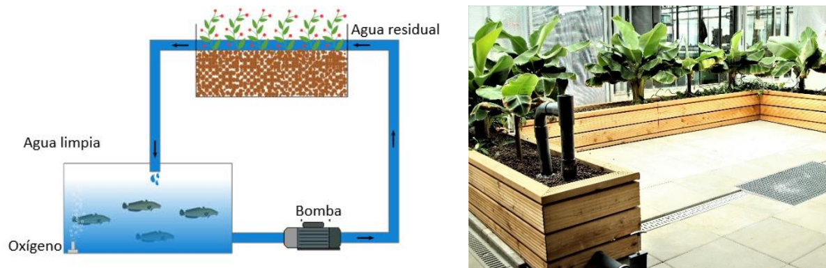
Figure 8: Técnica del lecho con sustrato. Izquierda – Esquema general para el sistema completo. Derecho – Un ejemplo del sistema en ZHAW Waedenswil (Foto: Robert Junge)
