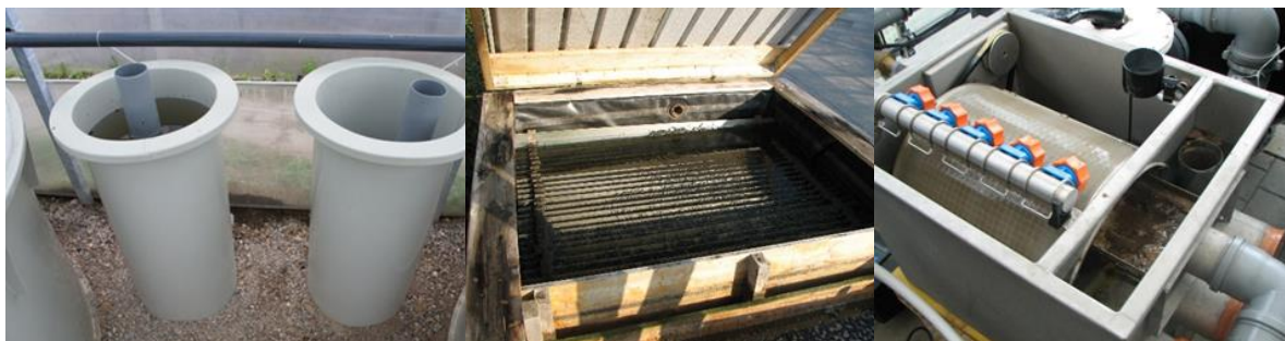
Figura 8. Diferentes dispositivos para separar sólidos: (izquierda) trampa de lodos; (centro) filtro de desbaste; (derecha) filtro tambor en ZHAW (fotos de U.Strniša)
