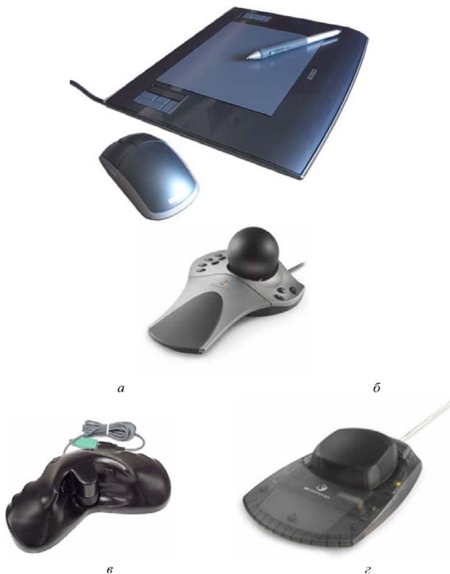
Рис. 4.2. Пристрої введення графічної інформації: а – цифровий планшет (диджитайзер) з маніпулятором миша; б – спейсбол; в – SD-маніпулятор; г – маніпулятор типу CadMan
