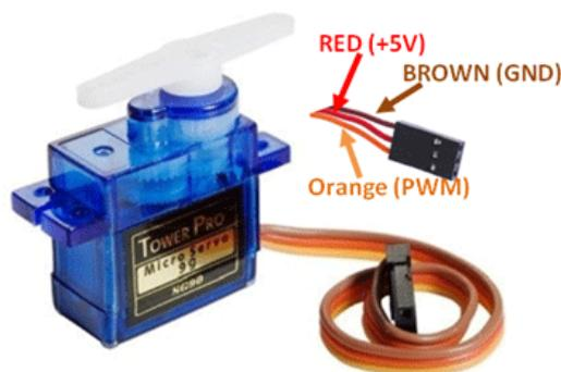
Fig. 3 Servo Motor
