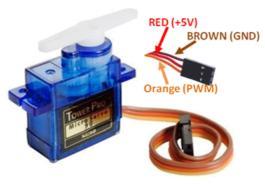
Fig. 3 Servo Motor
