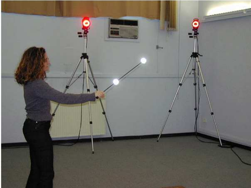
Figura 6.1: Esempio di calibrazione dinamica in un laboratorio stereofotogrammetrico. Nella foto si vede la bacchetta di calibrazione con i marker illuminati.
