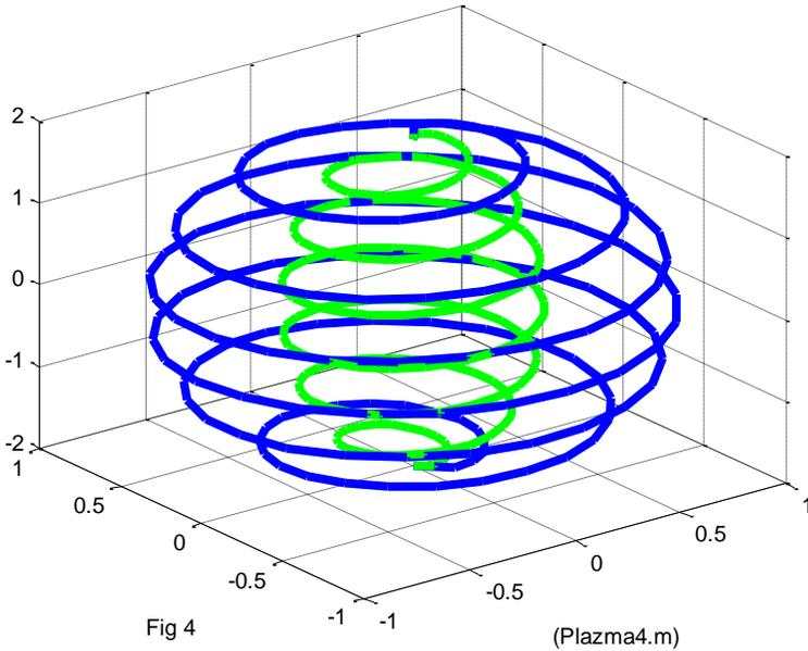
На основе этого предположения можно построить траекторию движения пылинок в соответствии с функциями (1-3). На рис. 4 показаны две винтовые, описываемые функциями  $j_r(r)$  и  $j_z(r)$  тока: при  $r_1 = \chi'(z)$  при  $r_2 = 0.5\chi'(z)$ , где  $\chi'(z)$  определена на рис. 3.
