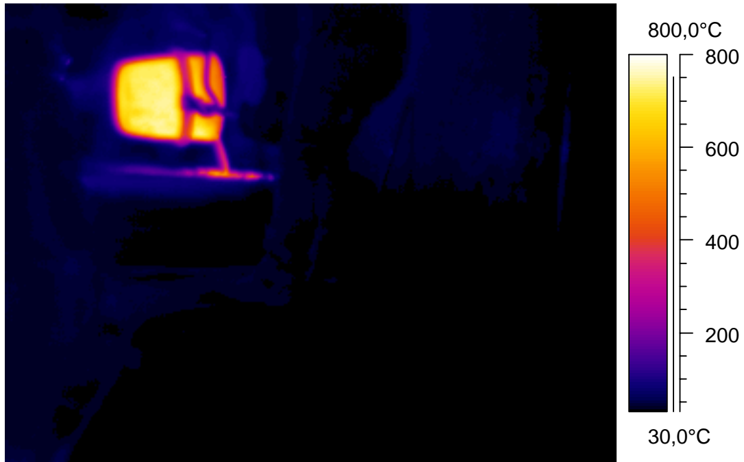
Εικόνα 3.9: : Θερμογράφημα κατά την διάρκεια χύτευσης χαλκού στο δευτερογενές εκμαγείο
