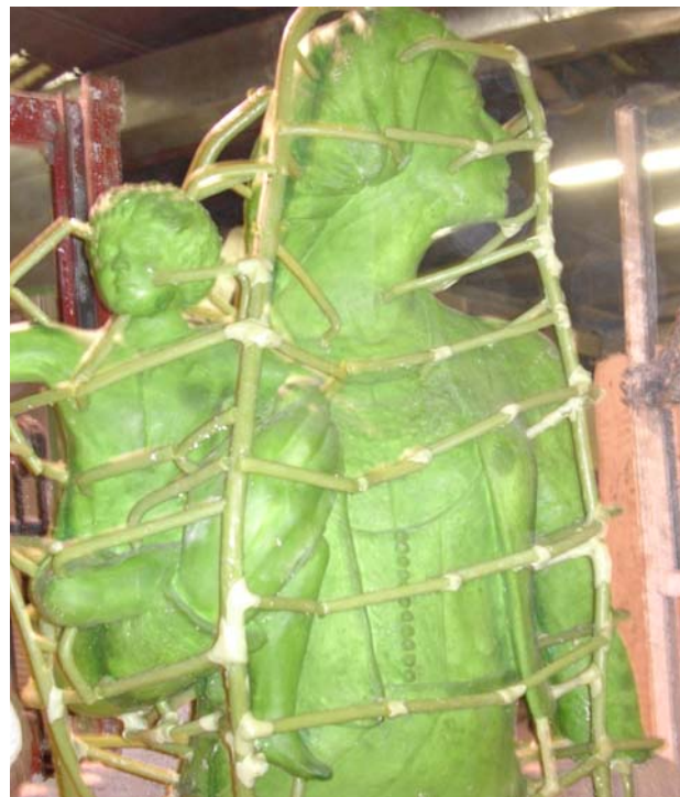
Εικόνα 12.20: Κατασκευή αγωγών χύτευσης σε κέρινο πρόπλασμα χυτεύσεως
