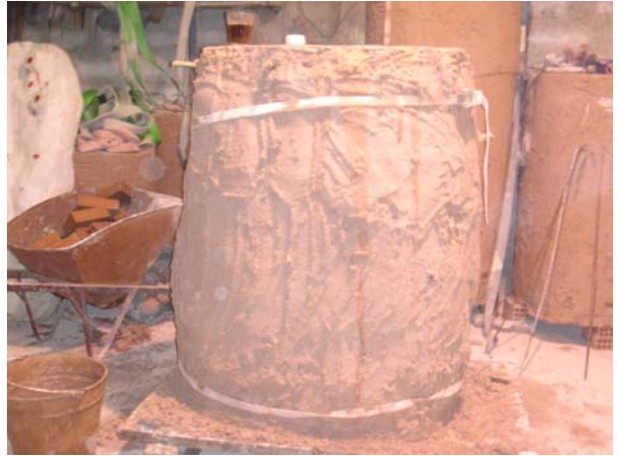
Εικόνα 12.21: Κέλυφος από κονίαμα γύψου-οπτής αργίλου
