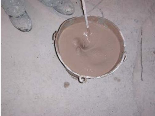
Εικόνα 3.2: Ανάδευση του κονιάματος του δευτερογενούς εκμαγείου
