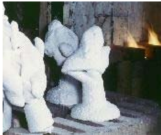
Εικόνα 12.24: Χώρος αποκέρωσης για κέλυφος από ασβεστόγαλα.
