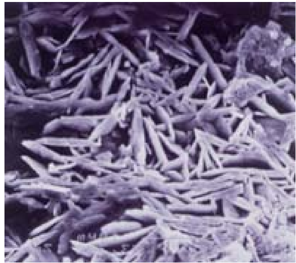
Εικόνα 15.4: Κρύσταλλοι γύψου επικαθήμενοι σε μάρμαρο μετά από διάβρωση του μαρμάρου (φωτογραφία από μικροσκόπιο) [40]
