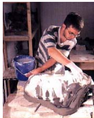
Εικόνα 10.6: Κατασκευή ελαστικού εκμαγείου με εσάρπα
