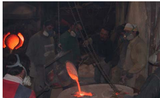
Εικόνα 3.5: Χύτευση χαλκού στο δευτερογενές εκμαγείο
