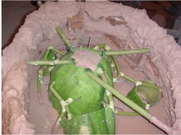
Εικόνα 12.21: Κέλυφος από κονίαμα γύψου-οπτής αργίλου
