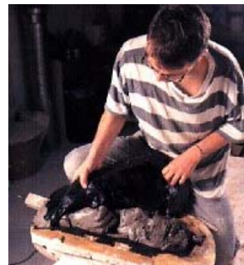
Εικόνα 10.6: Κατασκευή ελαστικού εκμαγείου με εσάρπα
