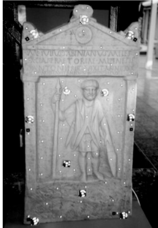
Εικόνα 7.13: Εφαρμογή της φωτοερμηνείας σε Ρωμαϊκό ανάγλυφο. Τοποθέτηση φωτοσταθερών
