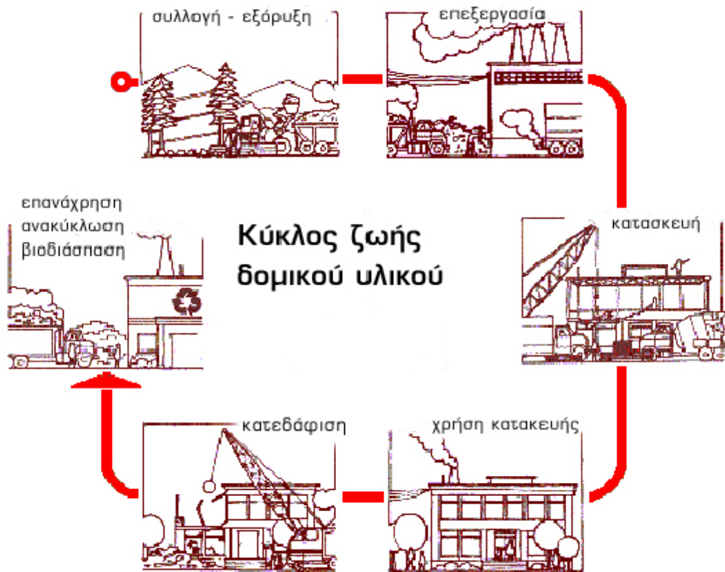
Εικόνα 2.11: Διάγραμμα ροής του κύκλου ζωής ενός δομικού υλικού
