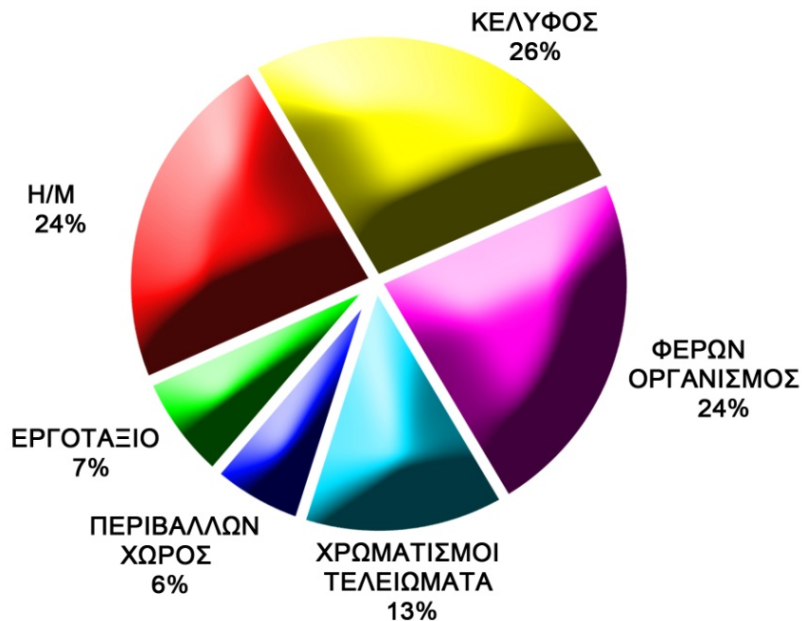
Εικόνα 15: Κατανομή της αρχικής ενσωματωμένης ενέργειας που χρειάζονται για να κατασκευαστούν τα μέρη ενός τυπικού κτηρίου γραφείων. [πηγή: Μετάφραση και απόδοση από Cole and Kernan, 1996]
