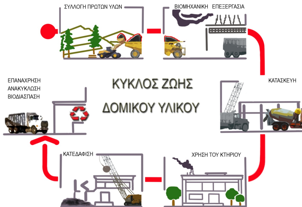
Εικόνα 2: Διάγραμμα ροής του κύκλου ζωής ενός δομικού υλικού
