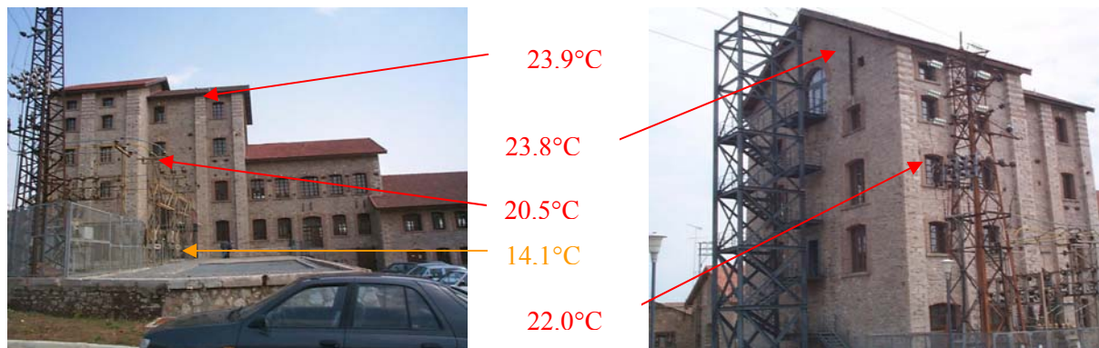
Εικόνα 2.2: Μετρήσεις θερμοκρασιών στο «Ξυλουργείο» (28-3-2002) Θέσεις μετρήσεων των θερμοκρασιών. Με κόκκινο σημειώνεται η εσωτερική θερμοκρασία και με κίτρινο η εξωτερική θερμοκρασία
