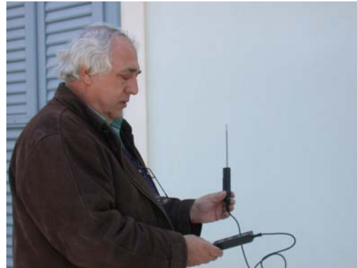
Εικόνα 2.6: Μετρήσεις με το θερμόμετρο περιβάλλοντος-επιφανείας
