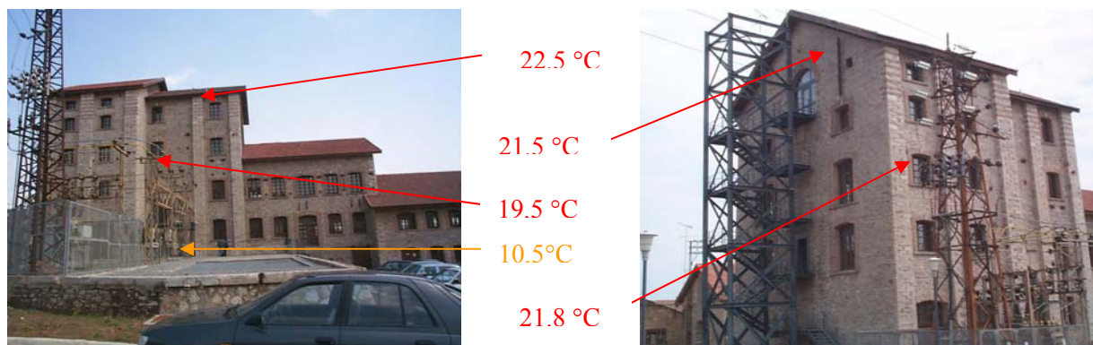
Εικόνα 2.1: Μετρήσεις θερμοκρασιών στο «Ξυλουργείο» (15-1-2002) Θέσεις μετρήσεων των θερμοκρασιών. Με κόκκινο σημειώνεται η εσωτερική θερμοκρασία και με κίτρινο η εξωτερική θερμοκρασία
