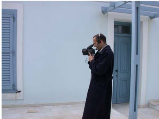
Εικόνα 2.5: Μετρήσεις με την θερμοκάμερα
