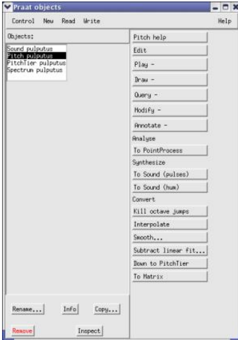
Kuva 4.2: Objekttilistassa olevia objekteja voi valita eli aktivoida hiirellä. Objektin kohdalla lukee ensin objektin tyyppi (esim. Sound tai Pitch) ja sen jälkeen objektin nimi, jota käyttäjä voi muuttaa. Objekti-ikkunan oikeassa reunassa olevan dynaamisen valikon sisältö muuttuu sen mukaan, minkä tyyppinen objekti on valittuna.
