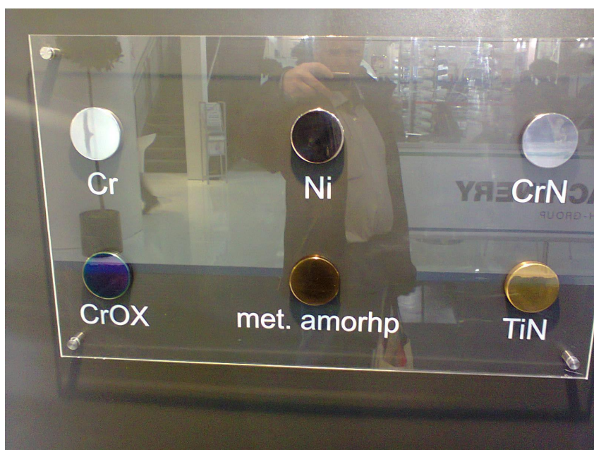
Рис. 1.6. Внешний вид типичных покрытий каналов течения расплава
