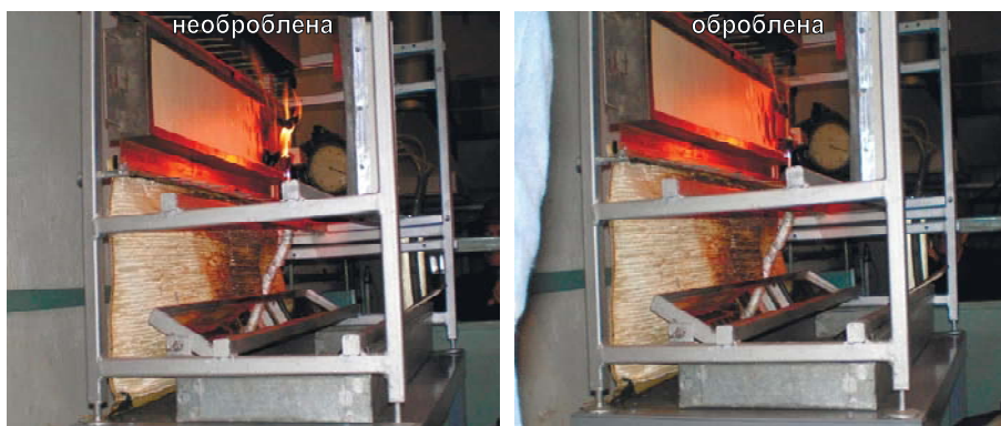
Фото 6.3 Процес дослідження поширення полум'я поверхнею деревини у горизонтальному напрямку
