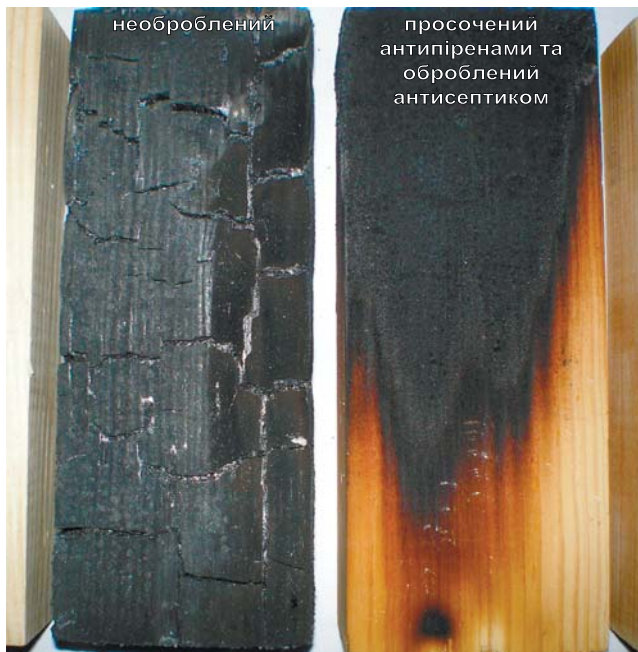
Фото 4.1. Зразки деревини після вогневих випробувань: а) необроблений, б) просочений антипіренами та оброблений антисептиком.
