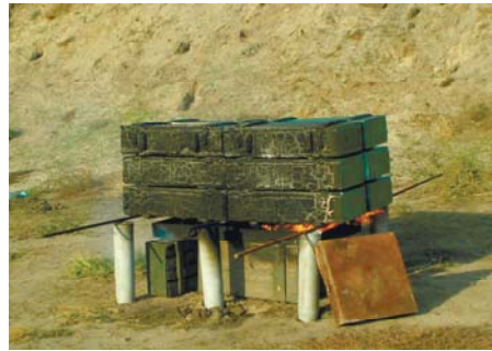
Фото 6.6 Затухання модельного штабелю укупорки для 122 мм пострілів з уламково-фугасним снарядом, яку вогнезахищено покриттям "Фенікс ДБ"
