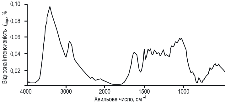
Рис. 2.27. ІЧ-спектр модифікованої деревини сумішами діамонійфосфату (20 %) і сульфату амонію (10 %) та антисептиком полігексаметиленгуанідин фосфат карбаміду
