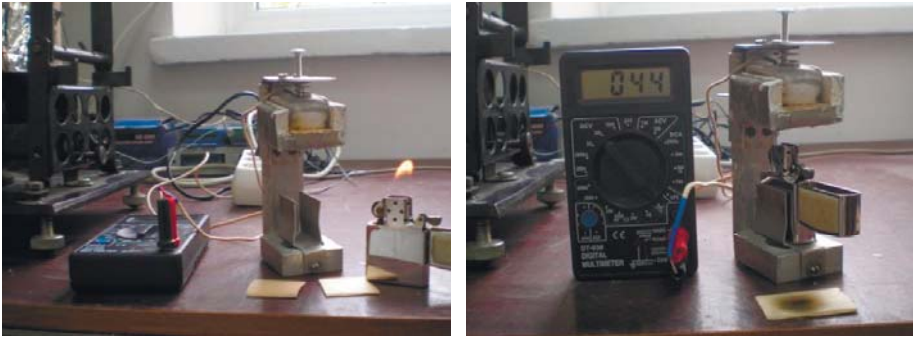
Фото 6.9 Обладнання для встановлення ефективності вогнезахисту поверхні деревини
