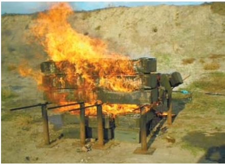
Фото 6.5 Руйнування конструкції модельного штабелю необробленої укупорки для 122 мм пострілів з уламково-фугасним снарядом
