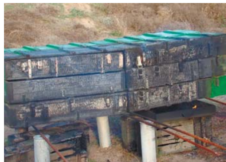
Фото 6.8 Затухання модельного штабелю укупорки для 122 мм пострілів з уламково-фугасним снарядом, яку вогнезахищено просочувальною сумішшю ДСА-2
