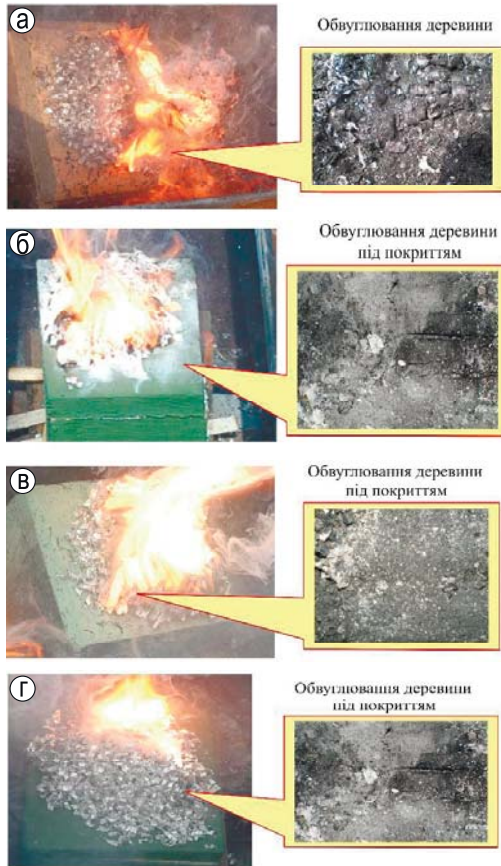
Рис. 9.62. Результати натурних випробувань зразків дерев'яної тари від дії напалму: а – №1; б – №2; в – №3; г – №4
