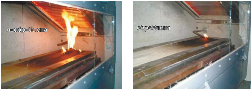
Фото 6.2 Процес дослідження поширення полум'я поверхнею деревини
