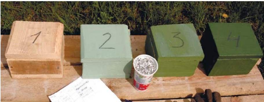
Рис. 9.59 Модельні зразки дерев'яних конструкцій: 1 – необроблений, 2 – оброблений вогнезахисним покриттям на органо-мінеральній основі; 3 – оброблений вогнезахисним покриттям на неорганічній основі [9]; 4 – оброблений вогнезахисним алюмосилікатним жаростійким покриттям з тепловідбивним екраном
