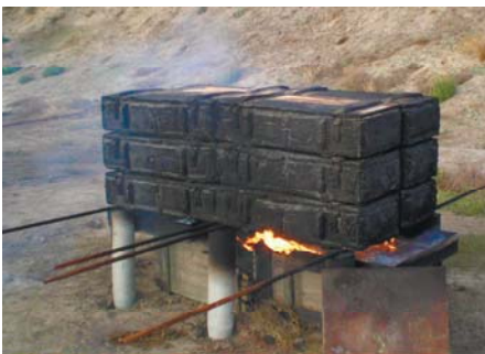
Фото 6.7 Затухання модельного штабелю укупорки для 122 мм пострілів з уламково-фугасним снарядом, яку вогнезахищено покриттям "Фенікс ДП"
