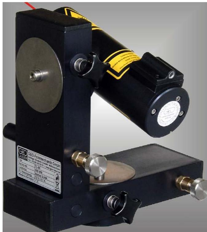
Abbildung 7-4: Tunnel-Laser TL-81<sup>39</sup>
