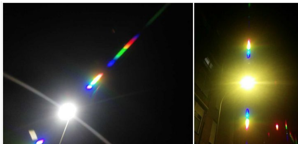
Figura 10. Espectros de fuentes tomadas demasiado cerca de las lámparas y mostrando saturación.
