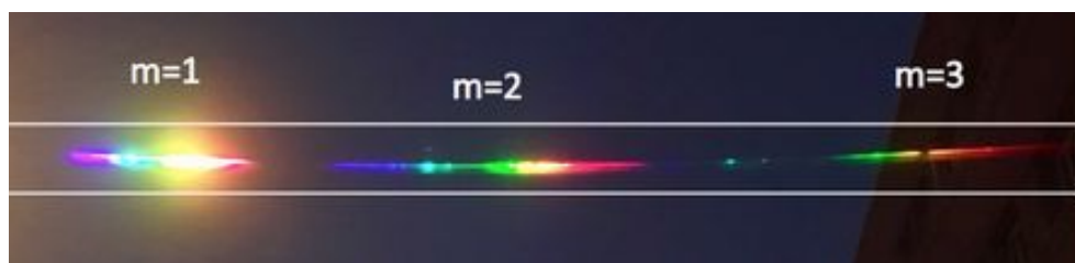
Figura 18. Espectro de HPS. El orden m=1 está saturado pero vemos en el orden m=2 que la mayor parte de la luz está en el amarillo y hay líneas de emisión presentes en azul-verde. En el orden m=3 , se ve la línea de absorción (raya negra) en 589 nm, partiendo el espectro del amarillo en dos.
