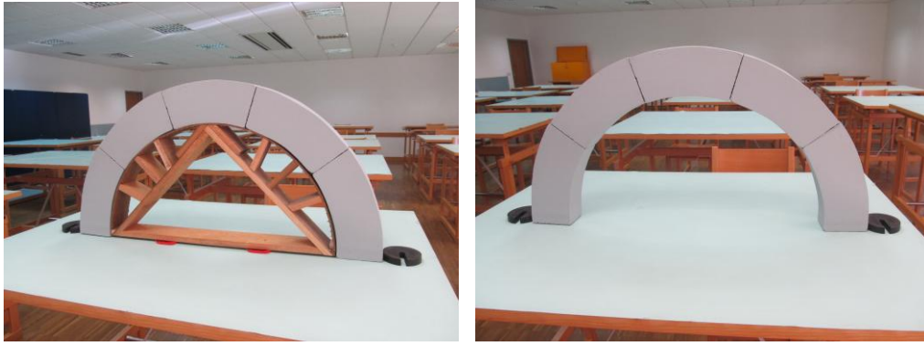
Fig. 19 – Modelo de arco com cimbre e autoportante (sem cimbre).
