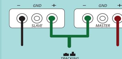
► essa configuração de conexão permite estabelecer um terra comum para ambos os circuitos e, consequentemente, saídas positivas e negativas de no máximo +32V e -32V, respectivamente.
