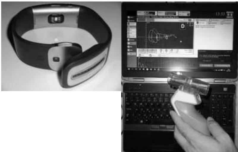
6. Ábra. A kísérlethez felhasznált eHealth okos eszköz és klinikai telemedicina spirométer
