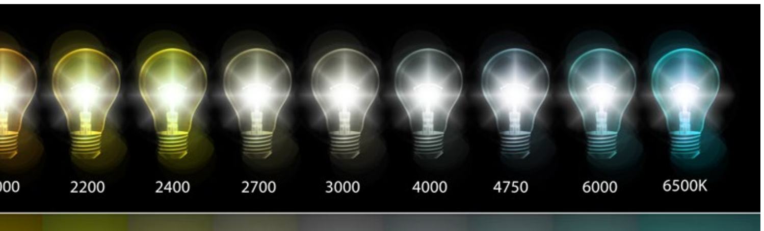
Sensación visual de color para bombillas de distinta temperatura.
