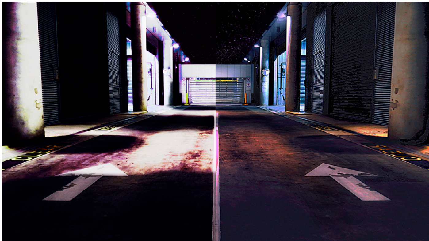
Una iluminación muy intensa pero poco uniforme (izquierda) es más insegura que una iluminación tenue uniforme (derecha).
