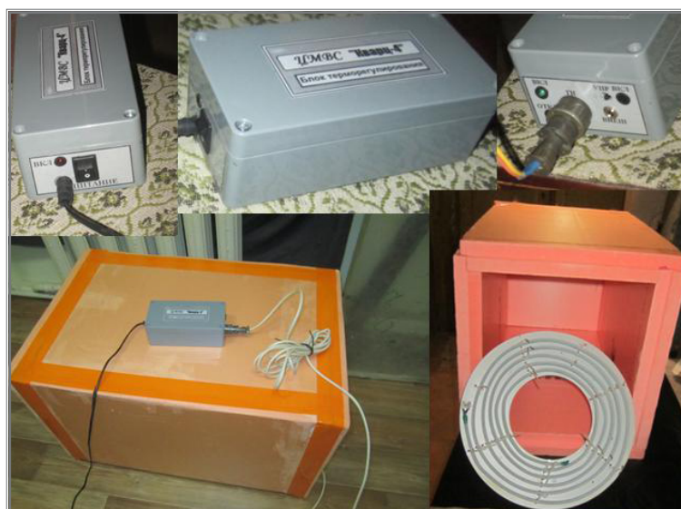
Рис.4. Термокамера для МИП МВС и блок терморегулятора
