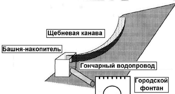
Рис. 16. Схема гидротехнической системы древней Феодосии
