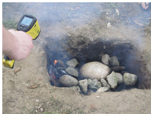
Abb. 4: Asparn/Zaya: Messung der Grubenwandtemperatur mittels Pyrometer VOLT CRAFT IR 1200-50D (Quelle: K. Brandtner).
