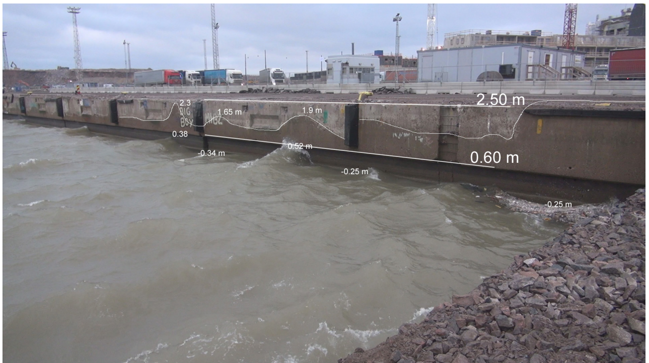
Kuva 9: Kuva joka havainnollistaa mille korkeudelle allon harjat ovat nouseet tarkastelemalla seinän kastumista. Kuva on otettu mittauspisteen 4 kohdalta. Kuva: Kimmo Kahma.
