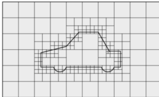
Abbildung 16: Schritt 3, Verfeinerung des Gitternetzes mithilfe der „snappyHexMesh“-Funktion
