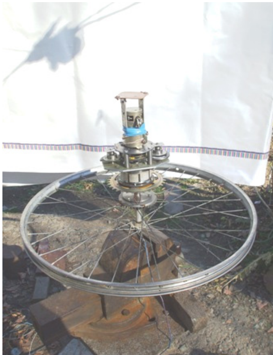
Фото 4 (сентябрь 2007г.). Модель для демонстрации возможности работы центробежного привода в безопорной среде. Вращение колеса или (и) корпуса вибратора происходит за счёт разной величины их моментов инерции.
