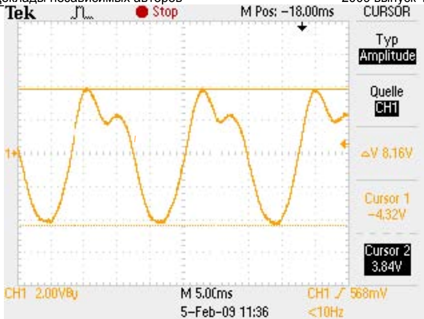
Фото 9. На стоп-кадре измерительного осциллографа видно, что синусоида искажена.
