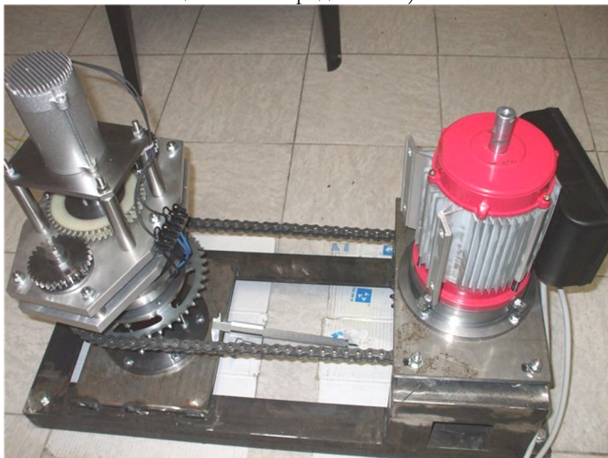
Фото 5 (Январь 2009г.) Модель привода для вращения ротора электрогенератора без использования промежуточного редуктора. Центробежный привод слева – улучшенный вариант образца на фото 3 (Австрия).
