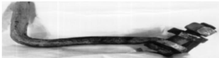
б) Разрыв скобы при 2-х недельной пляске проводов ВЛ 500 кВ, препятствующей допуску бригады к восстановлению последствий развития аварии, 1961 г.
