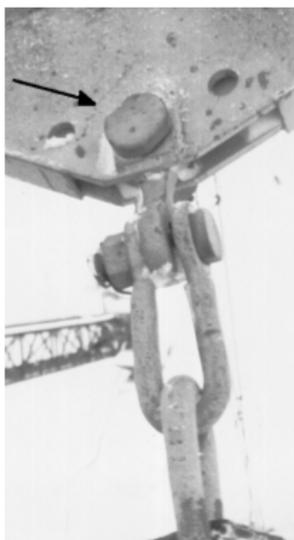
в) Усталостная трещина в проушине крепления гирлянды ВЛ 400 кВ. ВоГЭС-Москва, д. Беговатово, 15 км от г. Арзамаса.
