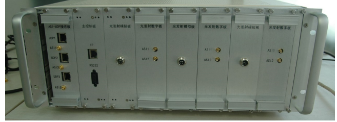
Fig. 8. The actual object of the optical transmitter.
