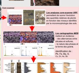
XRF Core Scanner Mes ide, 30s tous les 500µm, fenêtre de 2mm/50µm - composition élémentaire relative
