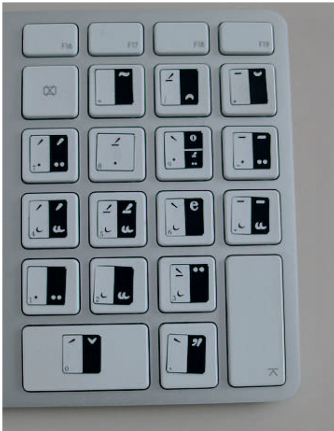
Abb. 1. Belegung der Sonderzeichen auf dem Dezimalblock und Anpassung der Tasten mit Tastaturklebern
