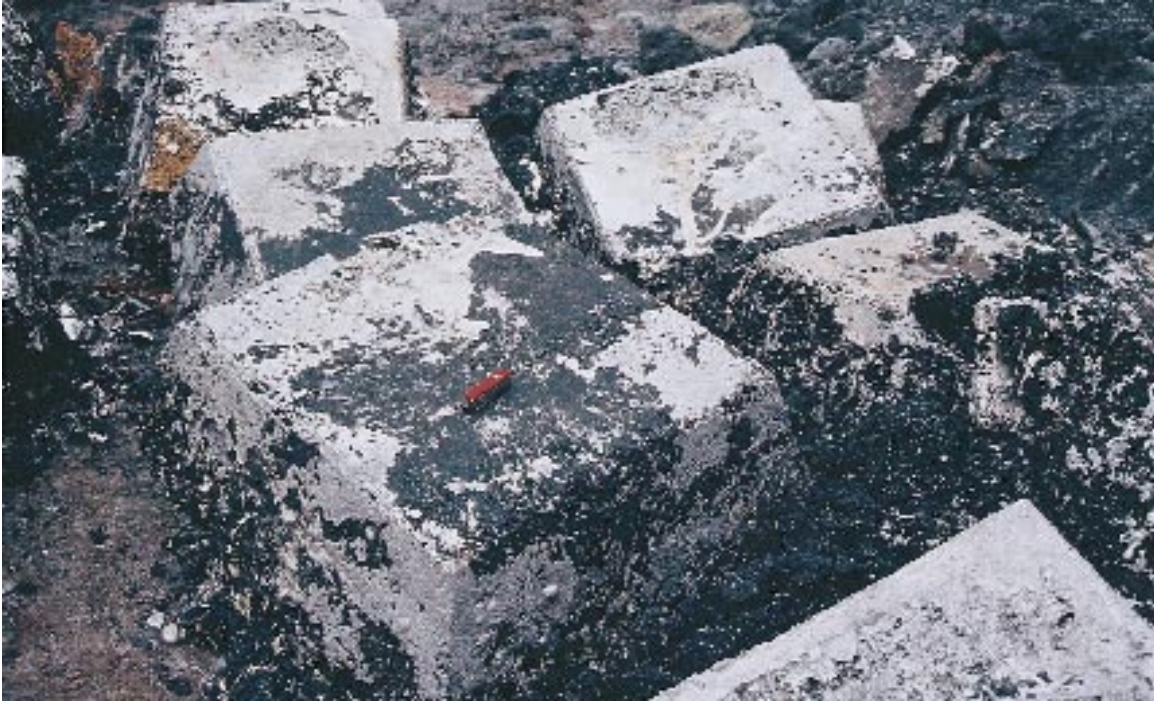
Figura 1. Escórias obtidas pela fusão de escórias e sucatas de alumínio em fornos que utilizam cloreto de sódio como fundente
