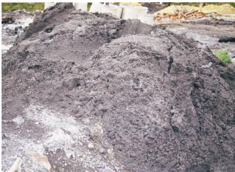
Figura 4. Depósito, diretamente sobre o terreno, de rejeitos sólidos que podem ser aproveitados para a fabricação de blocos de concreto
